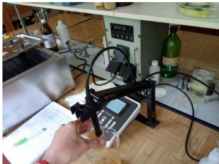
Obr. 2. Meranie elektrickej vodivosti medu (foto: V. Kňazovická, 2021)
