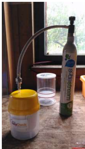
Obr.1: Zostava na diagnostiku za pomoci CO 2 . V pozadí iný typ komerčne predávanej diagnostической nádoby.
