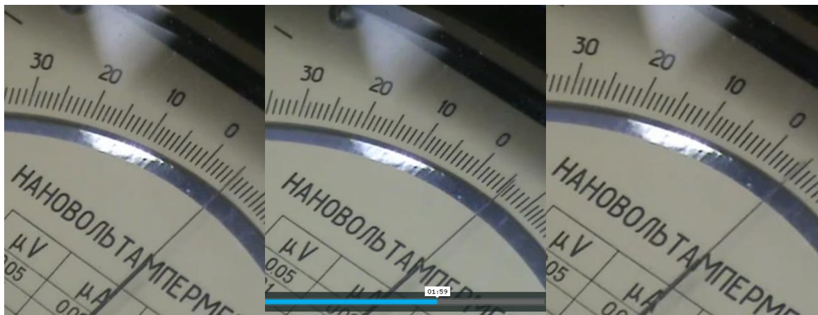
Рис. 6. Осцилляции стрелки индикатора нановольтамперметра (00:58-02:58)
