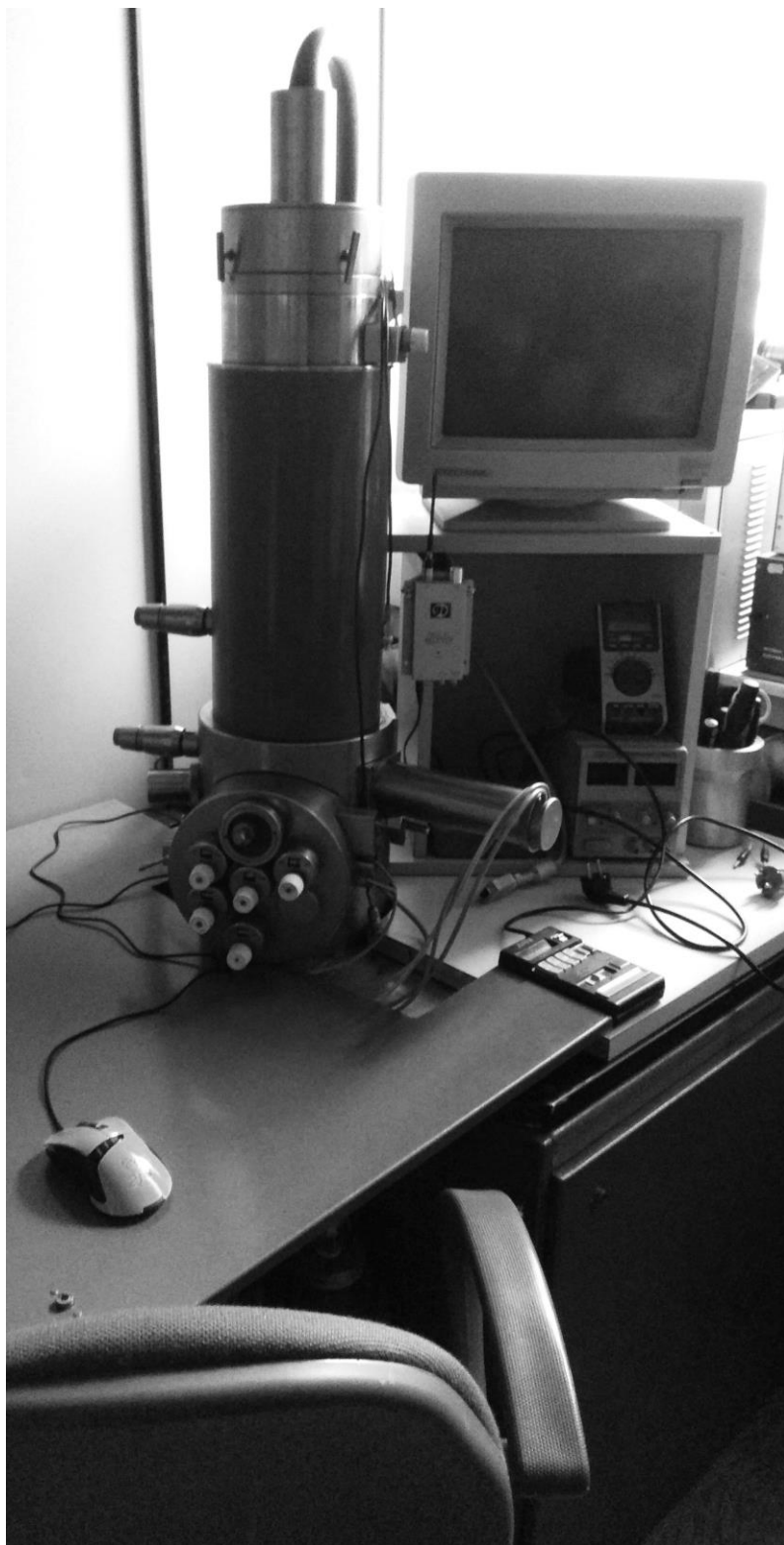
Рис. 1. Телеметрическая установка для безлинзовой микроскопии на базе колонны SEM
