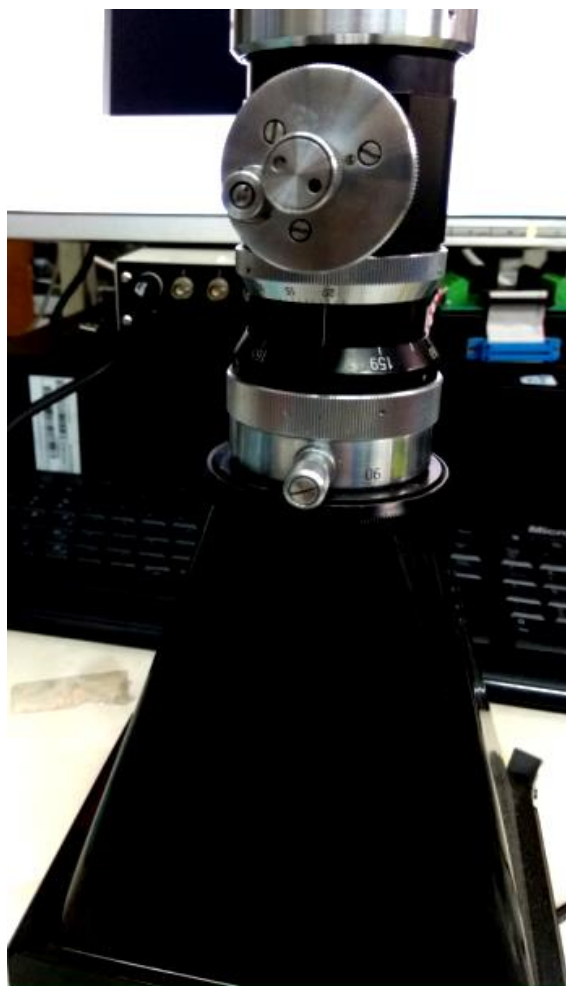
Рис. 3. Безлинзовый ПЗС-микроскоп с оцифровкой и поляризатором на входном тракте
