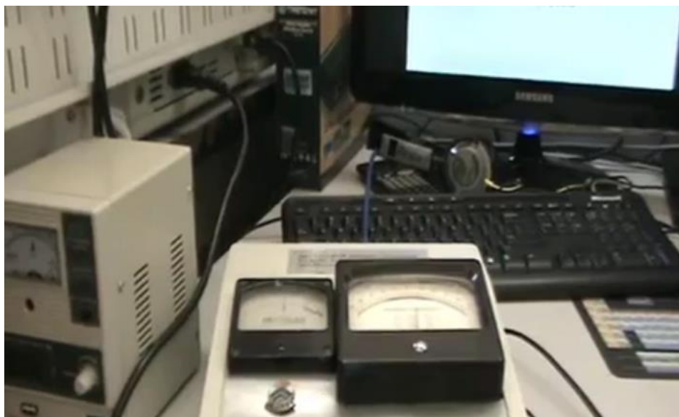
Рис. 1. Общий вид прибора, присоединенного по USB к автоматизирующему его ПК
