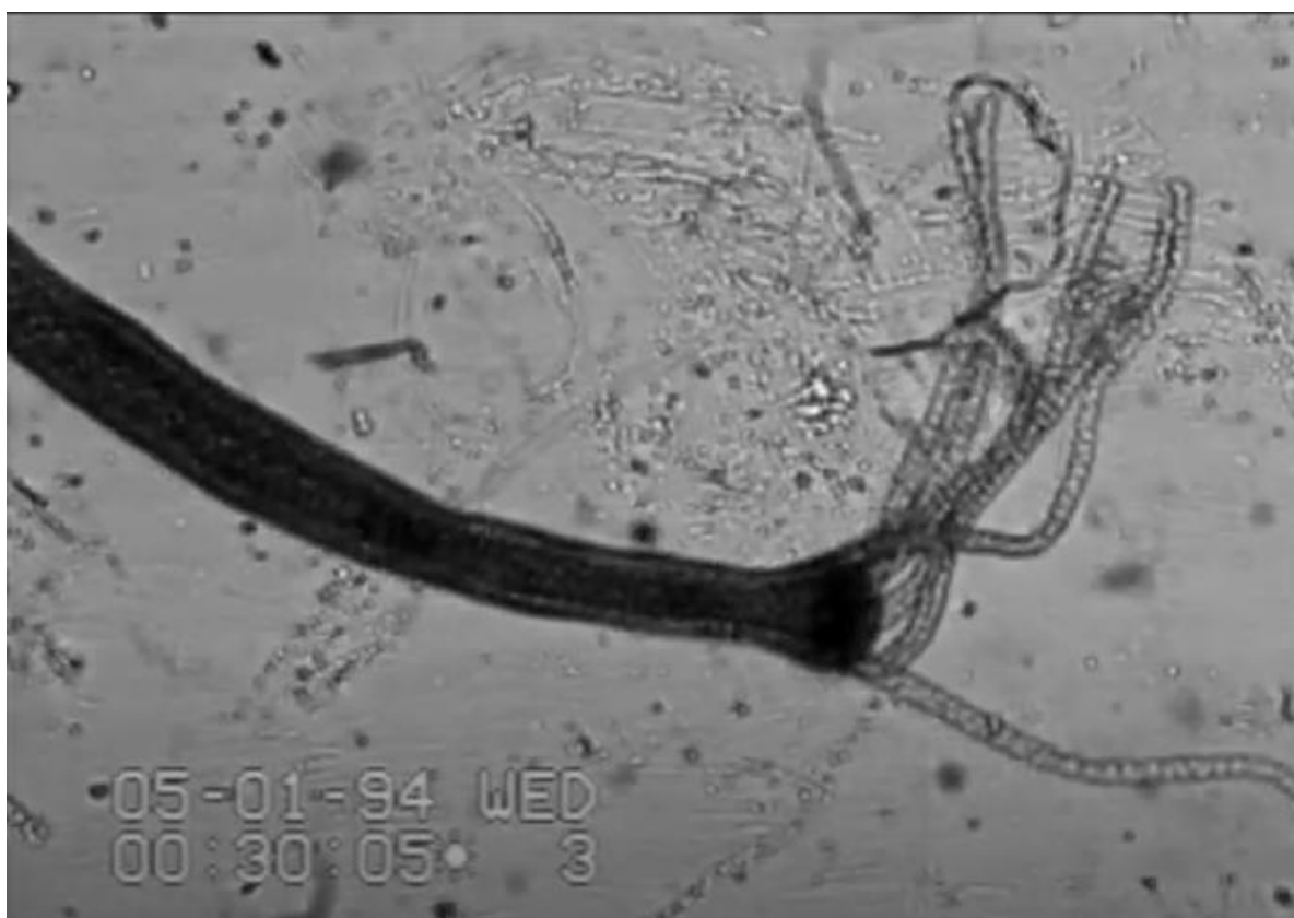
Рис. 7е. Гидра. Частотно-контрастная характеристика улучшена уменьшением длин волн
