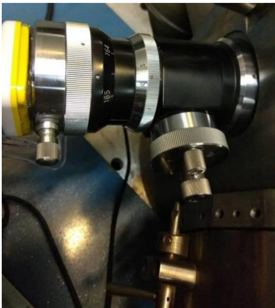
Рис. 2. Элементарное поляризационное звено PCLEM, подводимое к окну SEM
