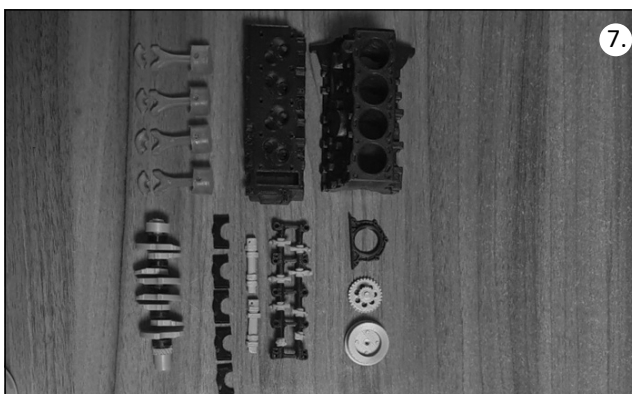
Obrázok 6: Model motora Toyota 22R-E s pohyblivými komponentmi, ktorý sa používal v Toyote Hilux
