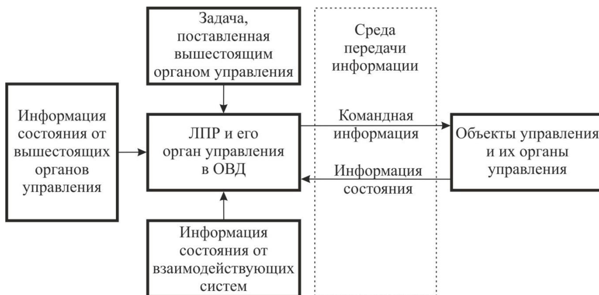
Рис. 3. Контур управления СОТС ОВД
