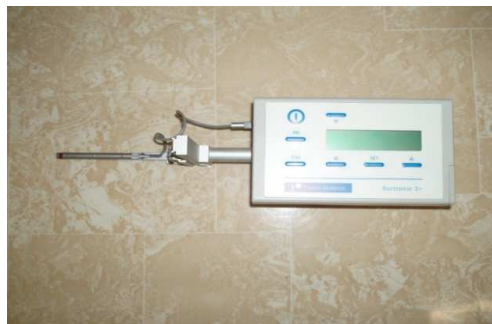
Fig. 4 Touch profilometer Surtronic 3 +
