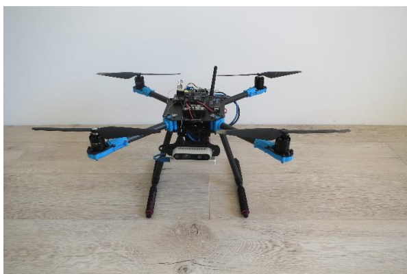
Obr. 4. Plne zostavený dron bez ochrannej kliečky
