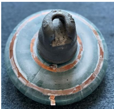
Obr. 5 Sklenený izolátor s elektródovým systémom
