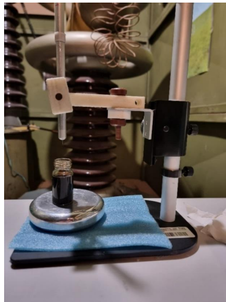
Fig. 4. Elektródový systém na meranie čiastkových výbojov
