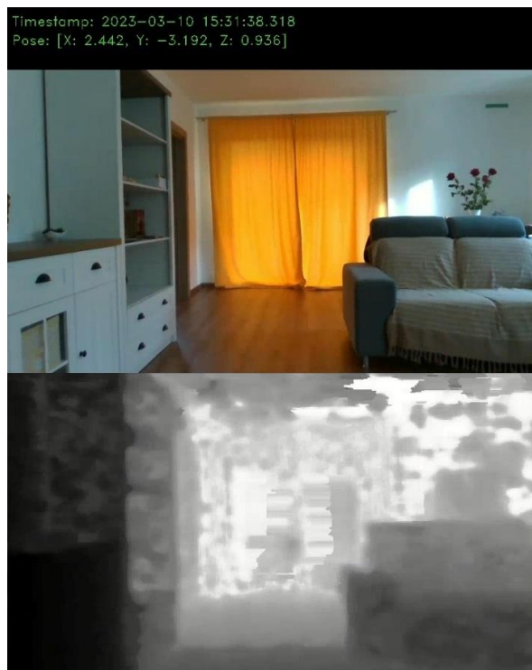
Obr. 8. Streamovanie videa. Hore: obrázok z RGB senzora; Dole: obrázok z hĺbkového senzora
