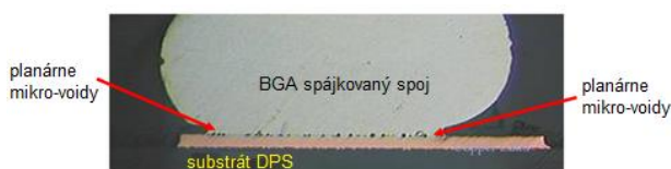
Obr. 3 Ukážka výskytu planárnych mikro-voidov na rozhraní spájky a povrchovej úpravy [19]
