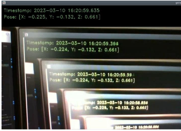
Obr. 9. Meranie latencie streamovania.
