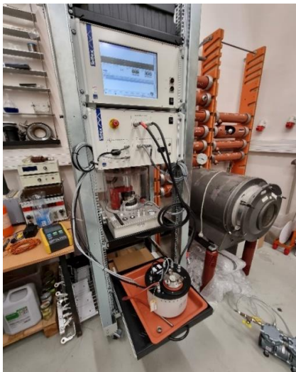
Fig. 3. Pracovisko na meranie teplotnej závislosti stratového činiteľa, relatívnej permitivity a objemovej rezistivity
