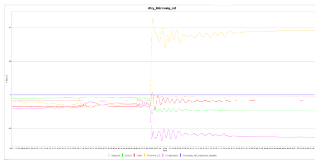
Obr. 6 Meranie uhlov napätia pomocou PMU jednotiek - ref. Stanica V. Kapušany
