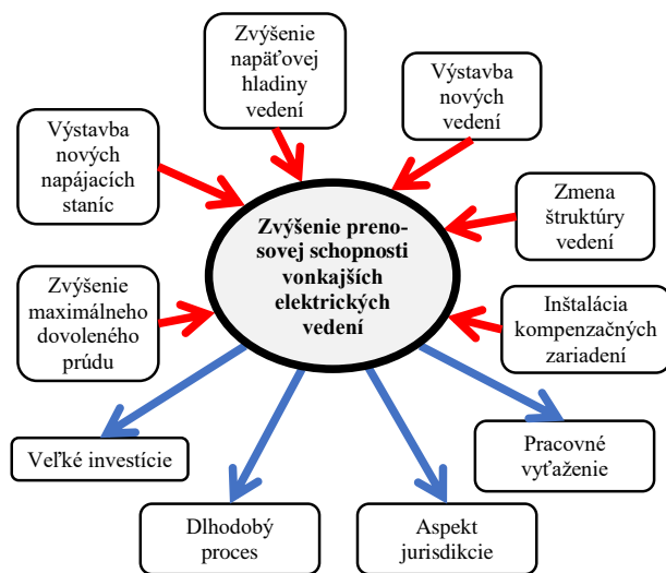
Obr. 1. Principiálny diagram zahŕňajúci proces zvyšovania prenosovej schopnosti vonkajších elektrických vedení [1].
