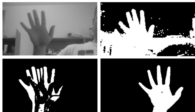
Obr. 11 Detekcia ruky a nájdenie centroidu pomocou kombinácie binárnych masiek [5]
