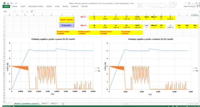
Obr. 5. Ukážka simulačného modelu pre dva paralelne zapojené DC/DC meniče so samostatnými kapacitami
