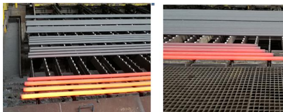
Obr. 4 Vplyv zmeny predbiehania materiálu na výslednú dĺžku letného strihu za na chladiacom rošte. Sidenor Basauri, Španielsko.
