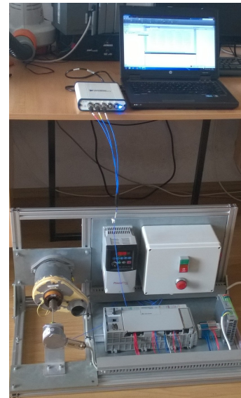
Obr. 24. Experimentálne pracovisko s laboratórnym modelom 3-fázový motor
