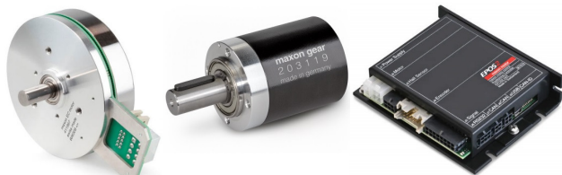
Obr. 3 Motor EC 90 so zabudovaným MILE enkodérom, planetárna prevodovka GP52, digitálny regulátor polohy EPOS2 24/5
