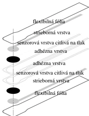
Obr. 6 Konštrukcia senzora FlexiForce A201 [5]
