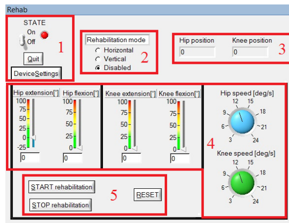
Obr. 4 Grafické používateľské rozhranie funkčného modelu, 1 - základné komunikačné nastavenia, 2 - výber rehabilitačného režimu, 3 - aktuálne pozície bedra a kolena, 4 - nastavenia pohybu, 5 - ovládacie tlačidlá
