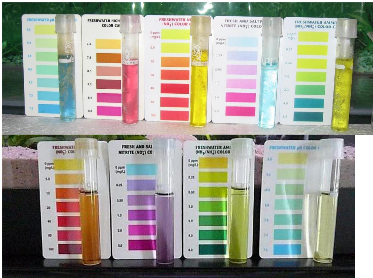
**Рис. 3.** Колориметрически-различные тесты на разные дескрипторы состояния воды
