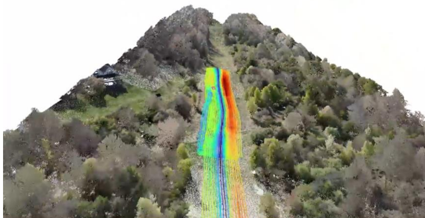
Obr. 4 Príklad zataženia potrubia na zosuvnom území
