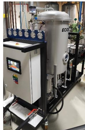
Foto č.7,8: Sušenie kompresorového oleja a príprava nového oleja na plnenie (zdroj: ECOFIL®)
