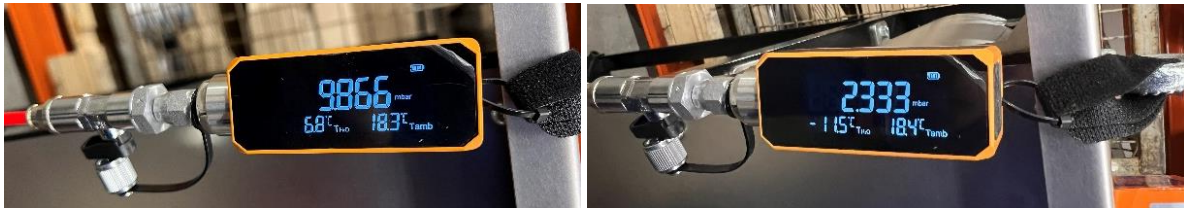
Foto č. 1 Meranie vákua s vizualizáciou teploty odparovania vody (zdroj: ECOFIL®)
