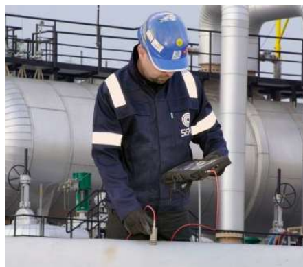
Obr. 8 NDT pred zváraním
