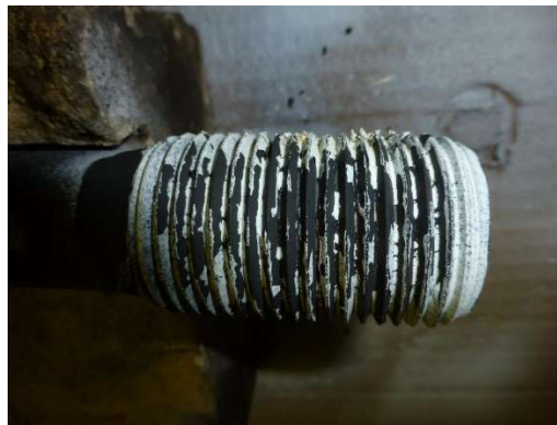
Obr. 12 Mazací pasta po teplotě 600 °C
