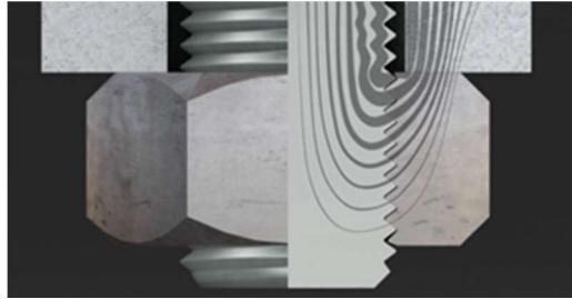
Obr. 4 Přenos zatížení přes první 3-4 závity
