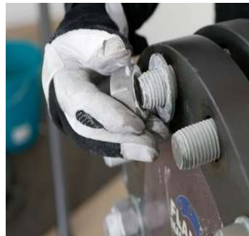
mazání čela matic a podložek
