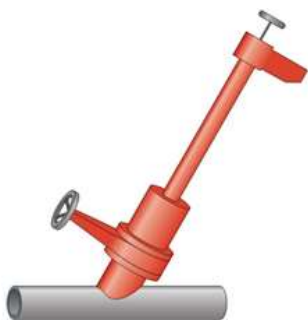
Obr. 5 Inštalácia nových ultrazvukových prietokomerov potrubia za prevádzky
