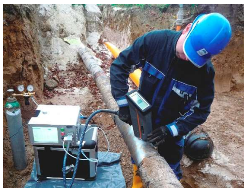
Obr. 7 Analýza základného materiálu
