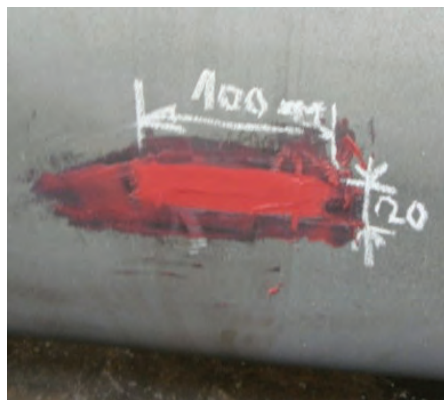
Obr. 12 Vyplnenie chyby výplňovým tmelom
