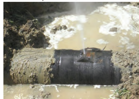
Obr. 8 Bodový únik vody
