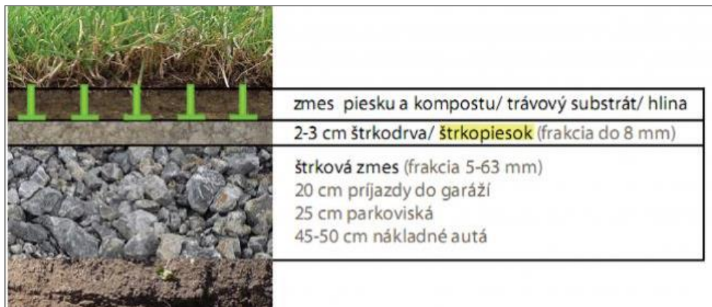
Obr. 1: Správne uloženie plastových zatravnovačov.
