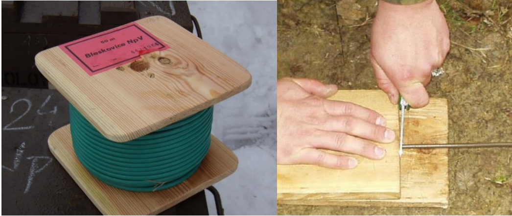
Obrázok 14 Bleskovica a spôsob jej rezania
