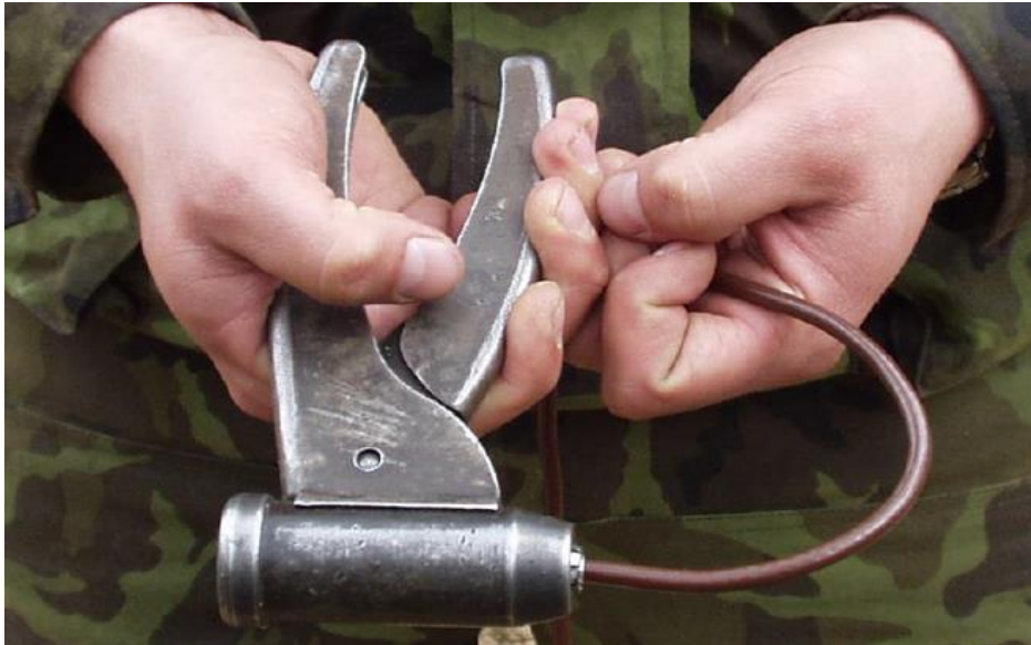
Obrázok 13 Spájanie zápalnice s rozbuškou Ž Zdroj: Archív autora
