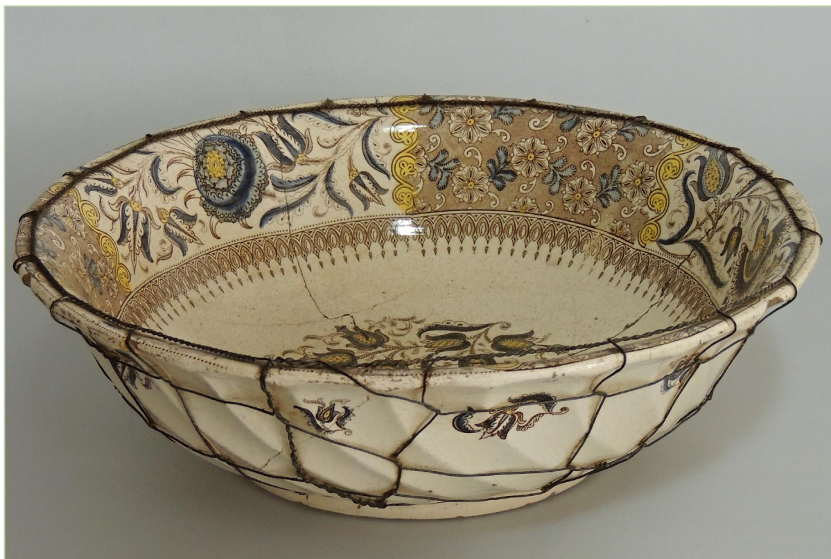
Odrôtovanie prasknutého riadu patrilo k najčastejším drotárskym prácam (Kysucké múzeum v Čadci)
