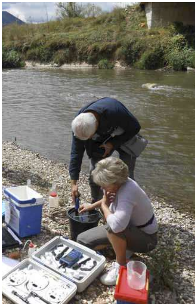
Obr. 3. Monitoring vody – odber vzoriek. Zdroj: Archív VÚVH
