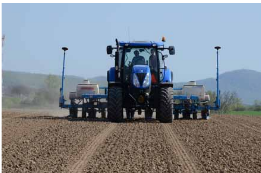
Obr. 5. Sejba kukurice v systéme riadeného pohybu strojov (CTF) na Vysokoškolskom poľnohospodárskom podniku SPU v Kolíňanoch (apríl 2013). Foto: Vladimír Rataj
