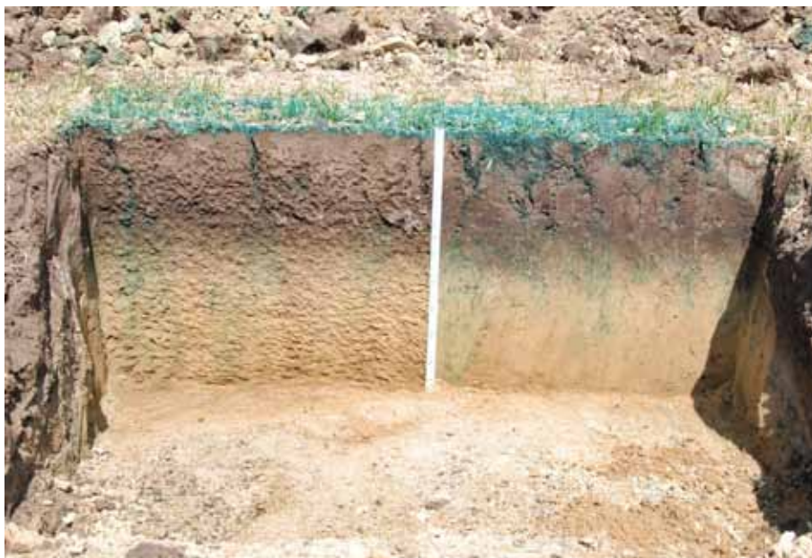
Obr. 8. Infiltrácia vody v cielene utlačenej pôde. Foto: Vladimír Rataj
