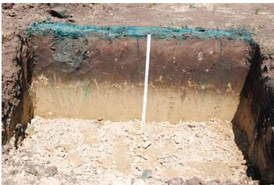
Obr. 9. Infiltrácia vody v pôde utlačenej viacnásobnými prejazdmi. Foto: Vladimír Rataj
