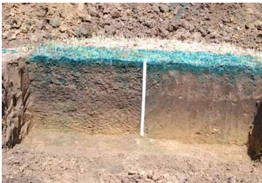
Obr. 7. Infiltrácia vody v neutlačenej pôde. Foto: Vladimír Rataj
