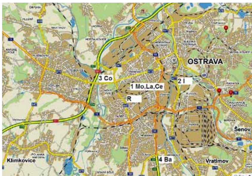
Obr. 2. Schematický plánek injektáže markerů La, Ce, Mo, Co, I, Ba v blízkosti znečišťovatelů a umístění receptoru R s filtrem
