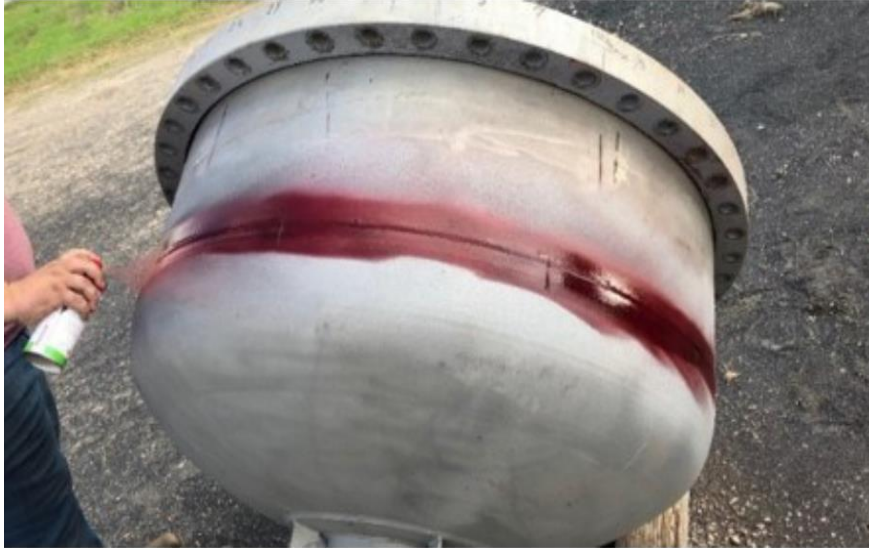
Obr. 10 Prasknuté veko výmenníka
