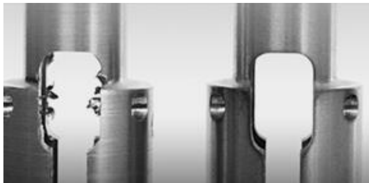
Obr. 3 Výsledok termického odihľovacieho procesu ľavý obrobok – pred odihľovaním; pravý obrobok – po odihľovaní
