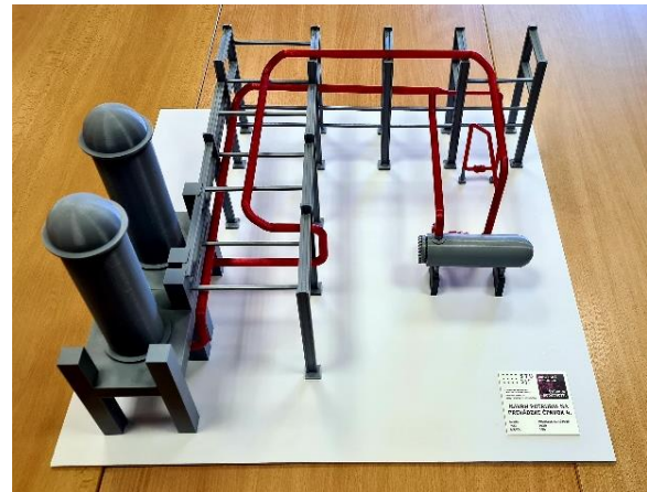
Obr. 21: 3D model v mierke 1:50 zhotovený 3D tlačou [1]
