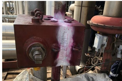
Obr.13 NDT uzatváracieho bloku po navarení
