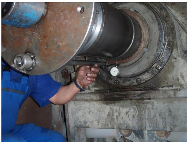
Obr. 4 Meranie hriadeľa s drážkami
