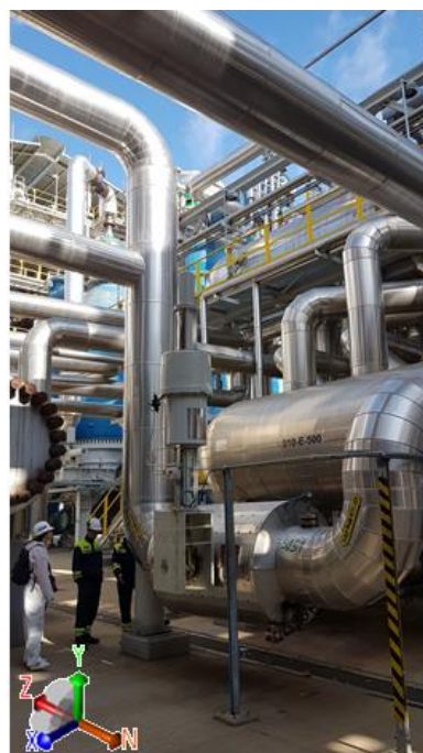
Obr. 4: Kritické miesto úniku syntézneho plynu v blízkosti ventilu [1]
