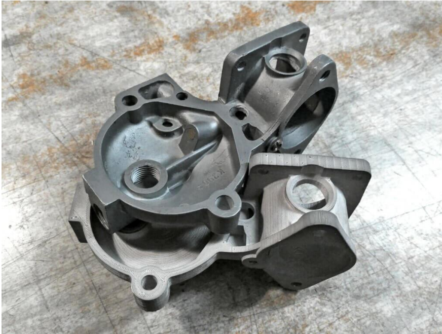
Originálny diel a jeho verná kópia z materiálu nerezová oceľ tlačená na 3D tlačiarni Markforged Metal X
