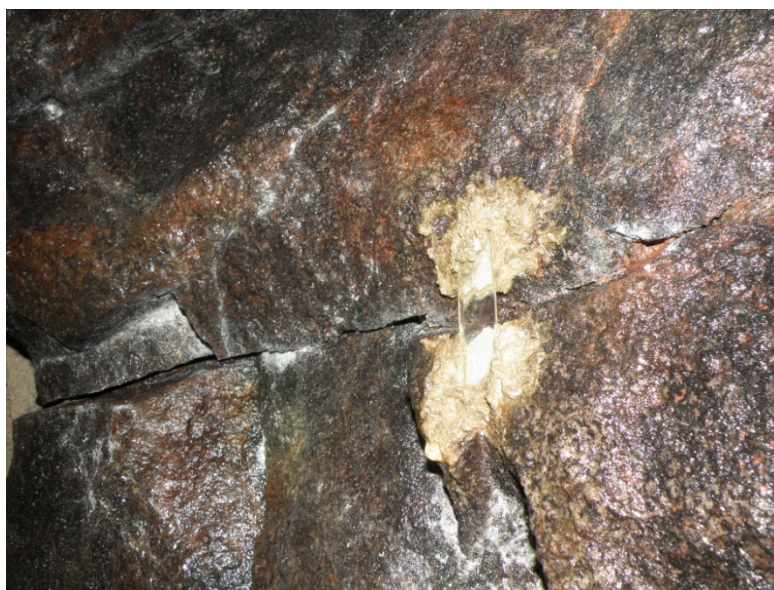
Fig. 7. A glass marker in a fracture in the underground space of the Jeroným Mine. (Photo: Lednická).
