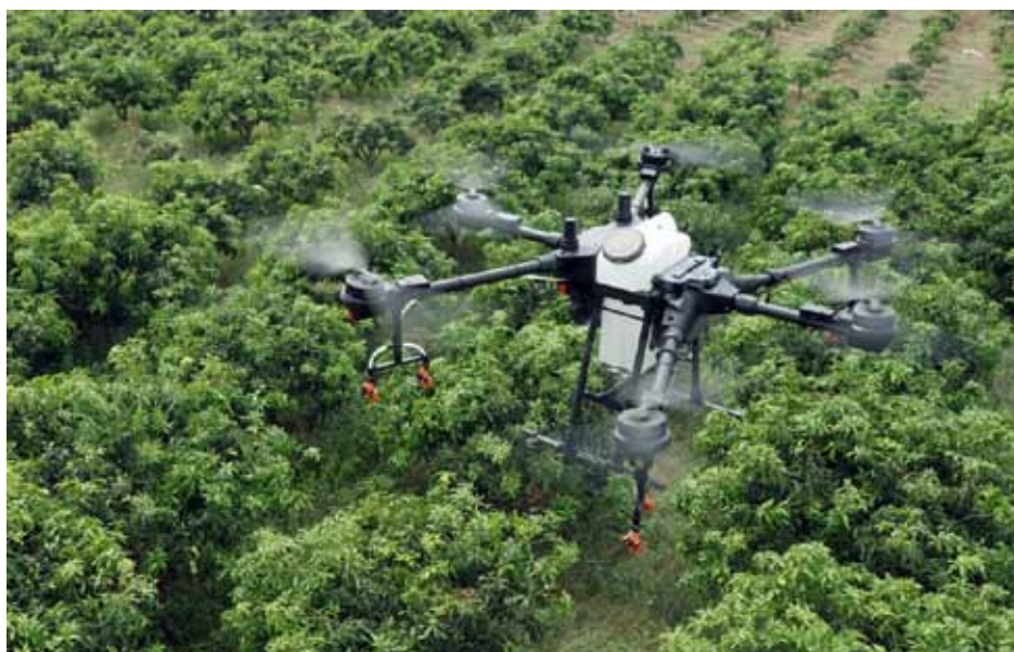
Obr. 6. Príklad bezpilotného lietajúceho prostriedku (UAV) používaného na aplikáciu agrochemických ochranných prostriedkov. Zdroj: dji.com
