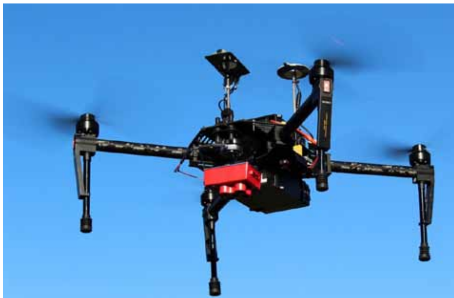
Obr. 1. (UAV) kategórie C2 s integrovanou multispektrálnou kamerou. Zdroj: mica-sense.com
